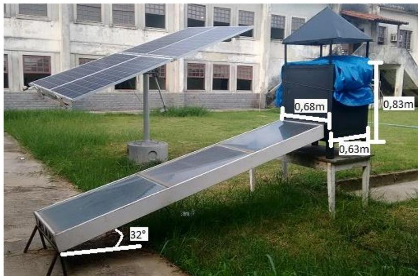
Figura 1 - Secador solar híbrido elétrico fotovoltaico
