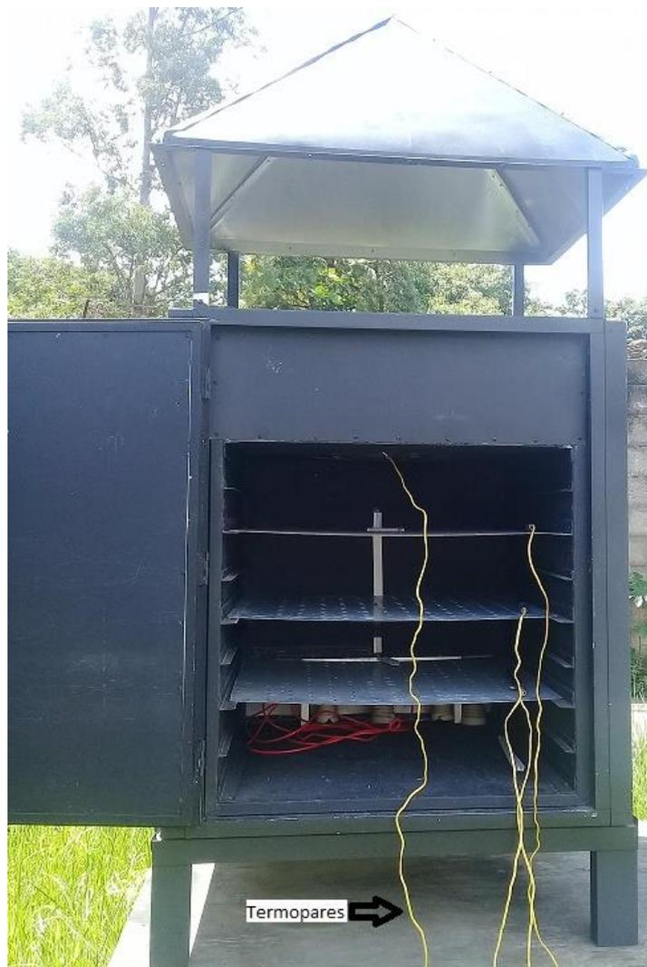
Figura 2 – Câmara de secagem com os termopares posicionados
