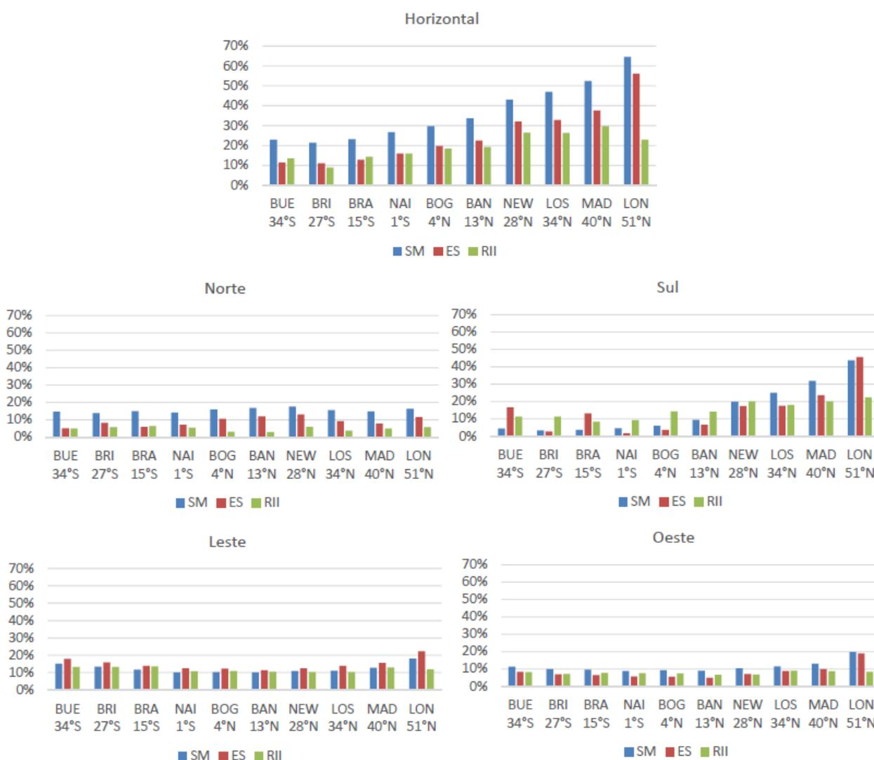
Figura 7 - Comparação entre o percentual de sombreamento anual por máscara de sombreamento (SM), por análise de exposição solar (ES) e o percentual de redução de irradiação incidente (RII) para as cinco orientações das superfícies analisadas.
