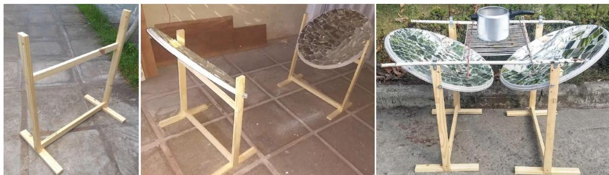
Figura 5 – Processo construtivo do fogão solar de duplo espelho parabólico. Fonte: o Autor.
