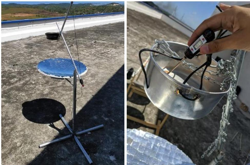
Figura 3 – Fogão solar de espelho parabólico com foco único construído. Fonte: o autor.
