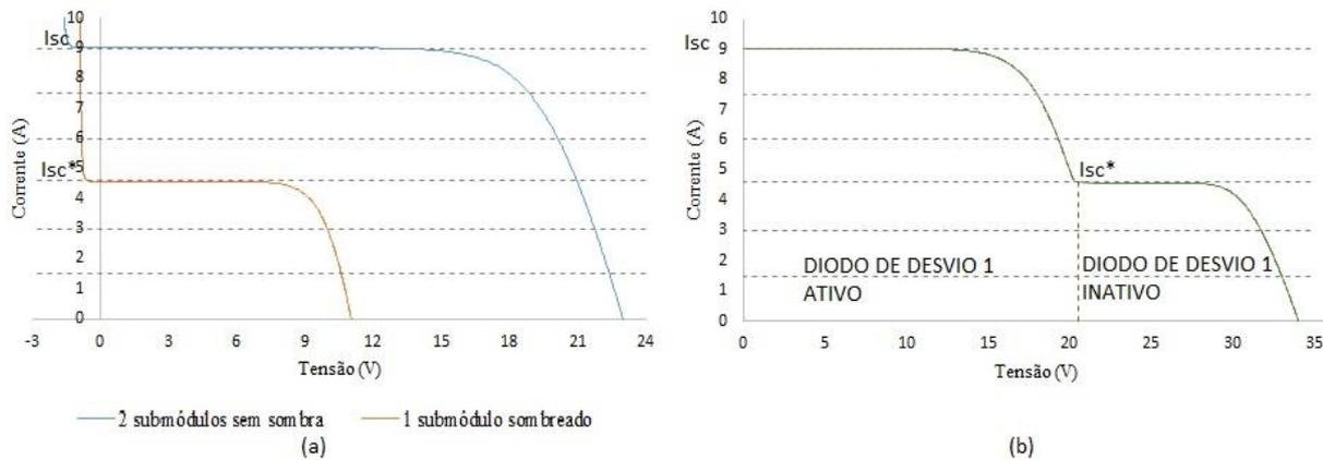
Figura 3 – (a) curvas  $I-V$  de um submódulo parcialmente sombreado e de dois submódulos em condição uniforme; (b) curva  $I-V$  do módulo FV sombreado, obtida pela soma das tensões dos submódulos para valores constantes de corrente.
