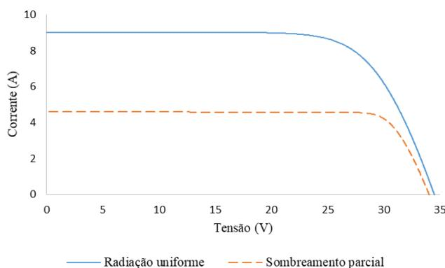
Figura 1 – Curvas  $I$ - $V$  de um módulo FV em condição de radiação uniforme e sombreamento parcial (50% de sombreamento) sem diodos de desvio.
