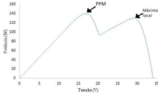
Figura 4 – Curva  $P-V$  de um módulo com um submódulo parcialmente sombreado.
