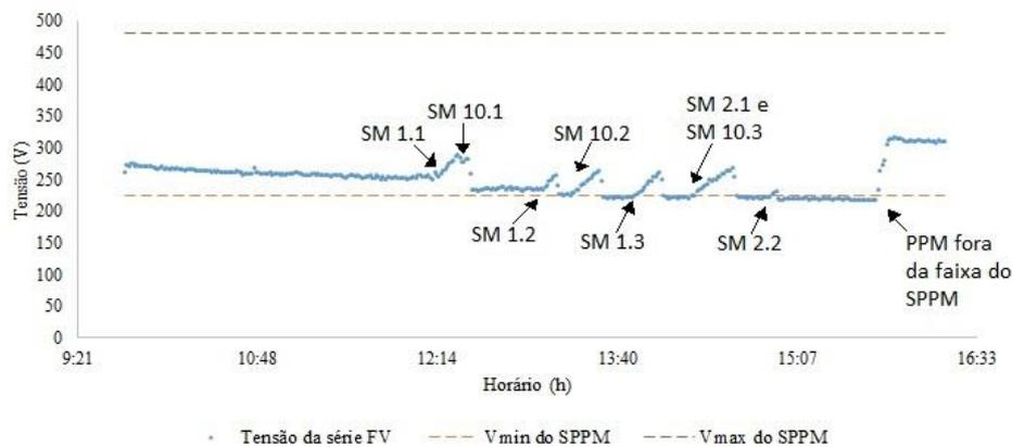
Figura 10 – Variação de tensão ao longo do dia com indicação dos aumentos na tensão e o submódulo (SM) correspondente.
