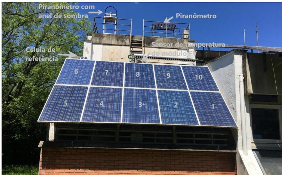
Figura 5 – Foto do sistema FV com os equipamentos de medição e os módulos identificados no LABSOL (UFRGS).
