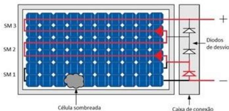
Figura 2 – Módulo FV com uma célula sombreada. Fonte: Adaptado de Vieira *et al.* (2020).
