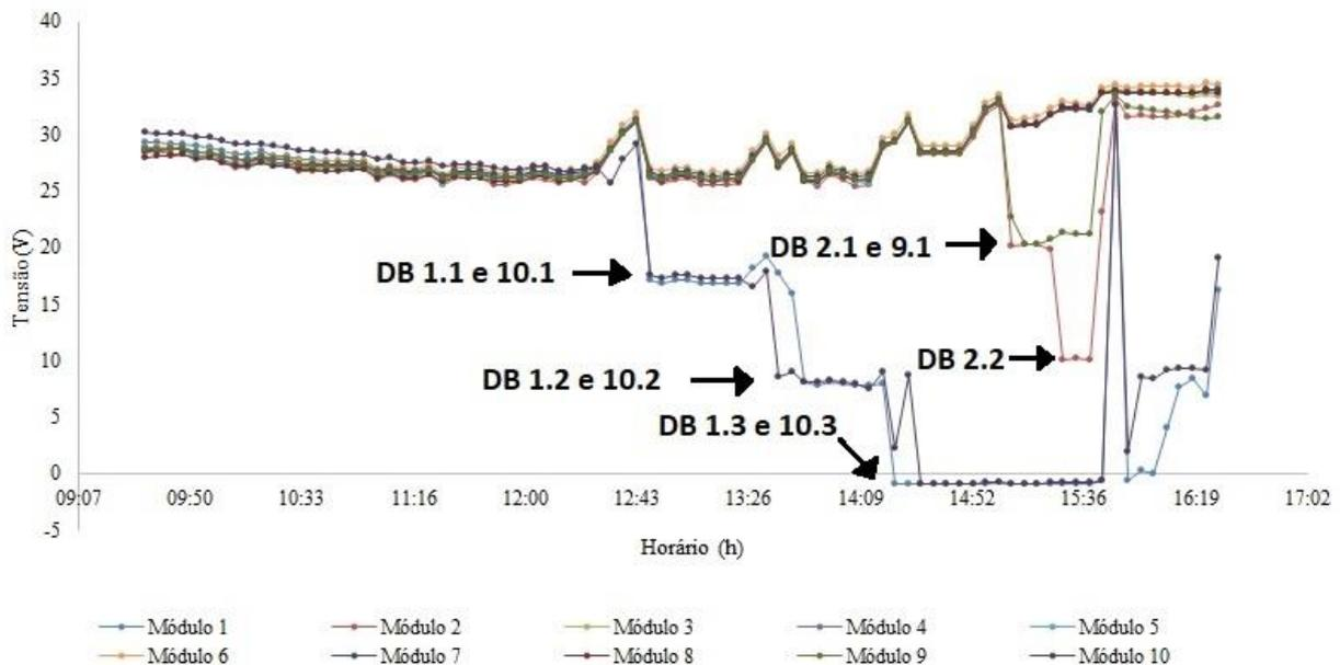
Figura 17 – Tensões individuais dos módulos ao longo do dia 22 de julho de 2021 com os diodos de desvio (DB) ativos indicados.
