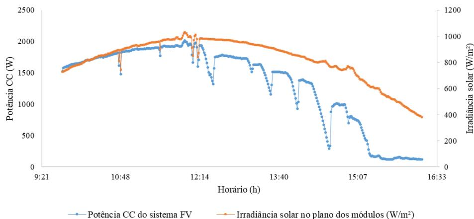
Figura 9 – Potência CC e irradiância solar medida no plano dos módulos ao longo do dia 05 de outubro de 2021.
