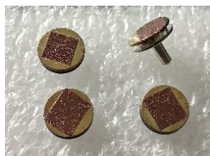
Figura 3 - Stubs após metalização.
