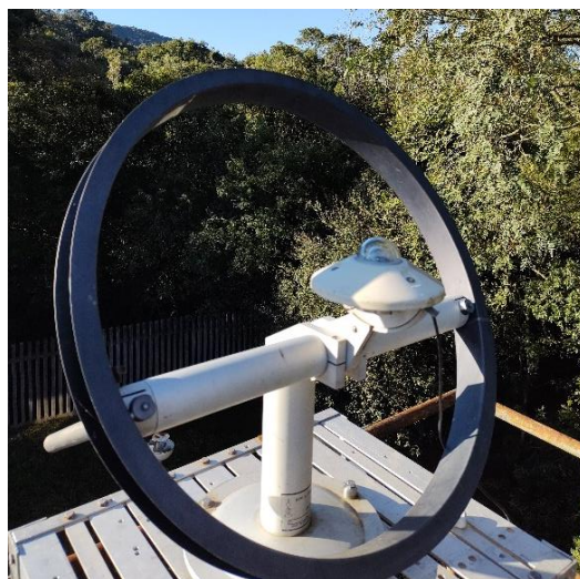
Fig. 2 – Piranômetro com anel de sombreamento acoplado para realizar medição de radiação solar difusa horizontal.
