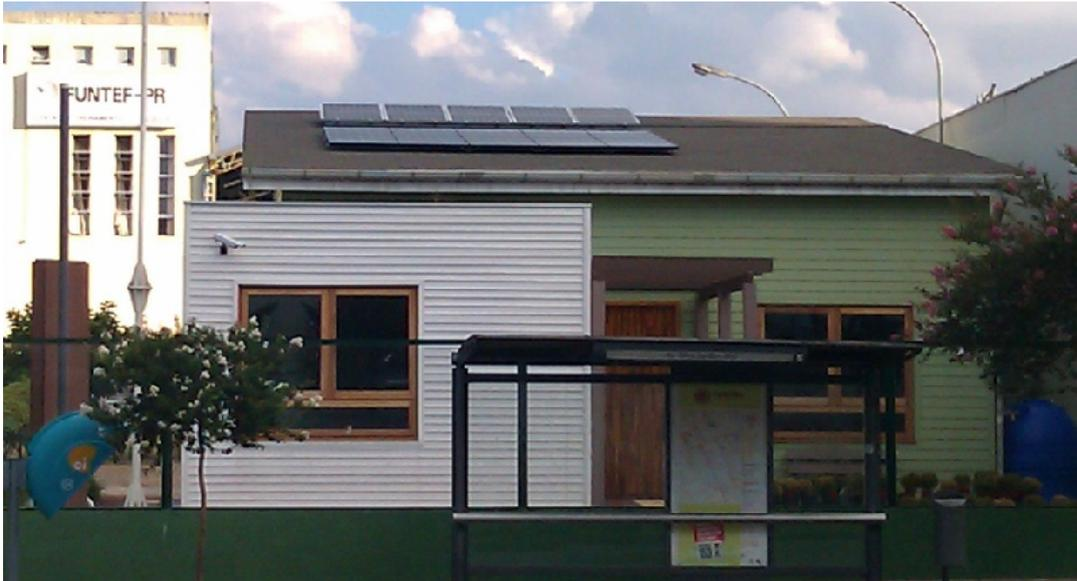
Figura 1 - Fachada com painel fotovoltaico na cobertura do Escritório Verde.
