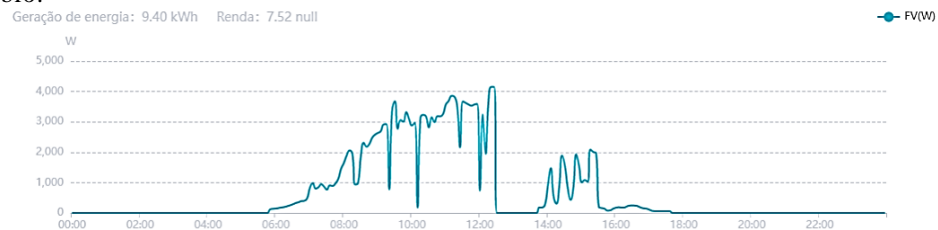
Figura 5 - Comportamento da Potência, em W, em um dia do mês de maio (Planta 2).
