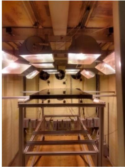
Figura 3 - Módulo fotovoltaico inserido no simulador de exposição solar.
