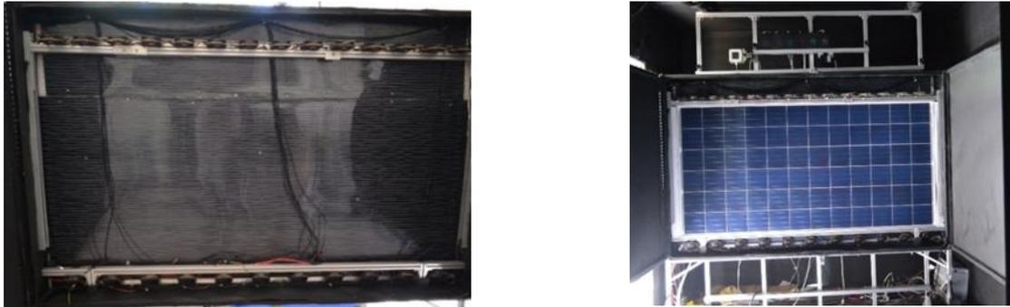
Figura 2 - Câmara de aquecimento aberta sendo à esquerda sem módulo e à direita com módulo de silício cristalino inserido.
