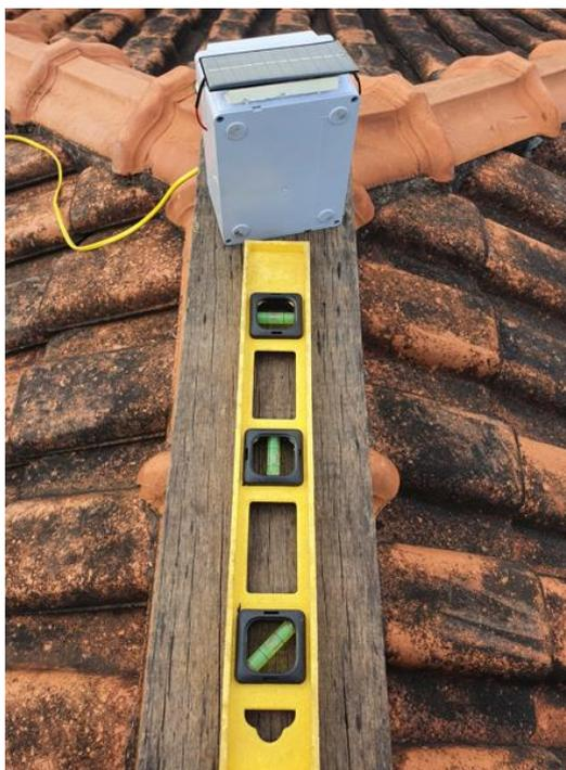
Figura 4 – Instalação do dispositivo de medição de irradiância.
