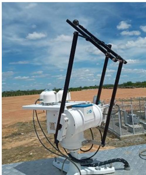
Figura 1 – Rastreador solar da EKO instalado na Plataforma Solar de Petrolina (CRESP).
