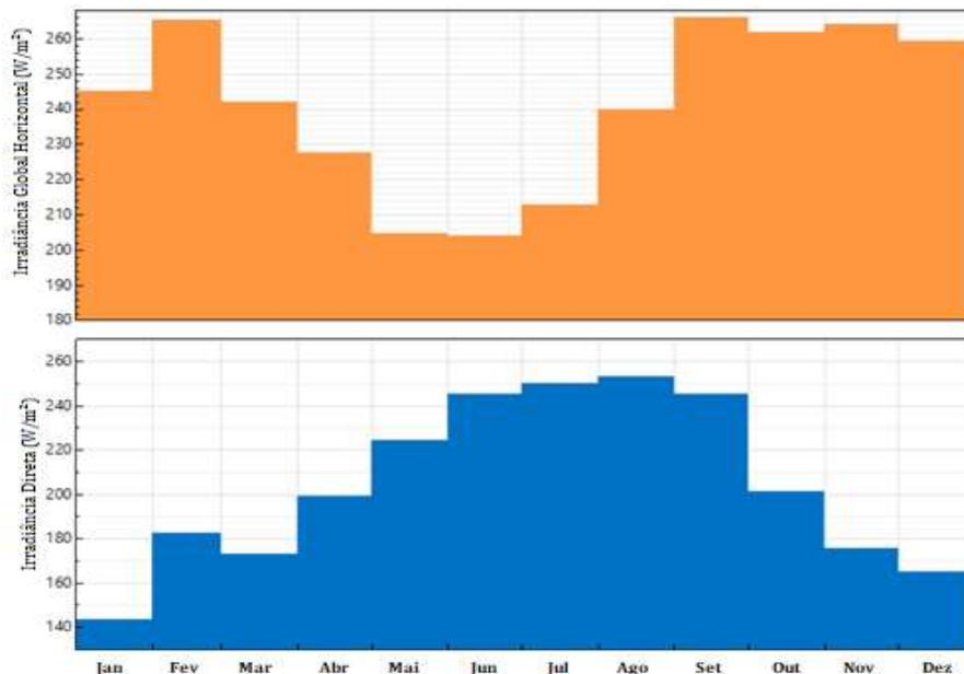
Figura 2 – Gráfico de Irradiâncias Global Horizontal e Direta médias mensais fornecidas pela estação meteorológica.
