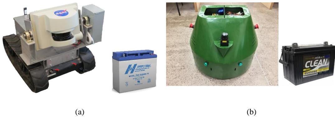
Figura 1. Robôs autônomos do GPAR movimentados por, (a) esteira, e (b) rodas giratórias
