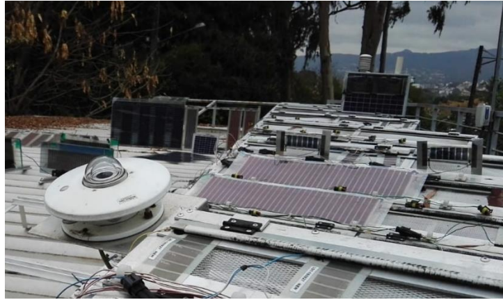
Figura 2 – Suporte com as amostras para o teste outdoor . As amostras Horizontais foram colocadas em uma estrutura de alumínio com inclinação de 20° e orientado para o Norte entre as duas amostras Verticais, presas em cada extremidade a uma adaptação para o ângulo de 90°. O piranômetro foi instalado na mesma posição da estrutura.
