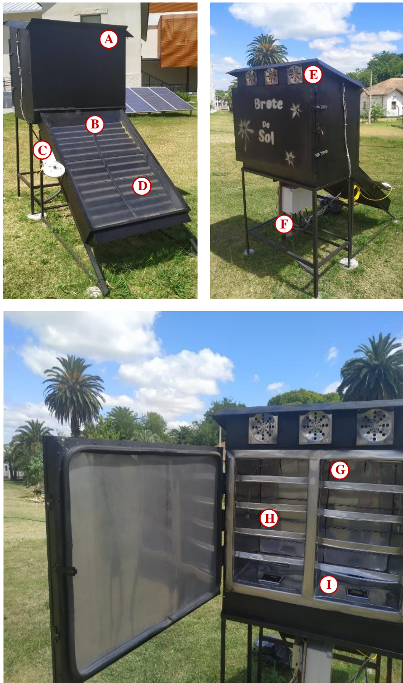
Figura 1 – Prototipo de secado solar activo del tipo indirecto. (A) Cámara de secado; (B) Sensor de temperatura en la salida del colector (C) Piranómetro; (D) Colector solar de aire; (E) Salidas de aire; (F) Sensores de temperatura y humedad ambiente externo y Dataloggers ; (G) Sensor de temperatura en la cámara de secado; (H) Sensor de humedad; (I) Ventiladores.
