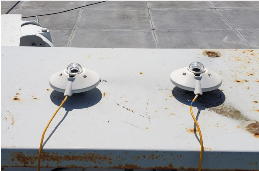
Figura 4 – Ensaio de determinação das incertezas dos piranômetros.
