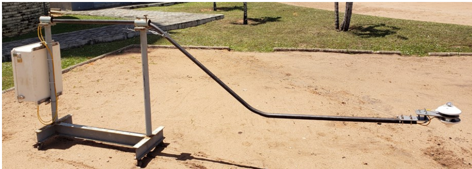
Figura 2 – Bancada móvel de medição de albedo
