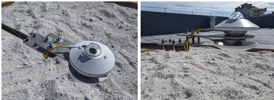
Figura 3 – Detalhe do sistema de nivelamento dos piranômetros
