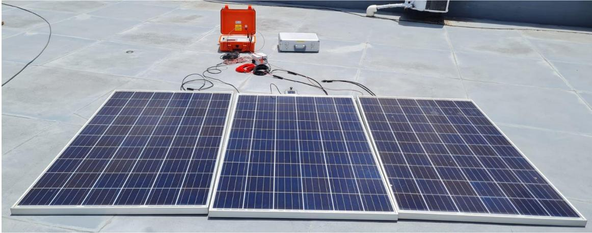
Figura 6 - Vista da realização do ensaio utilizando o traçador de curva I-V.
