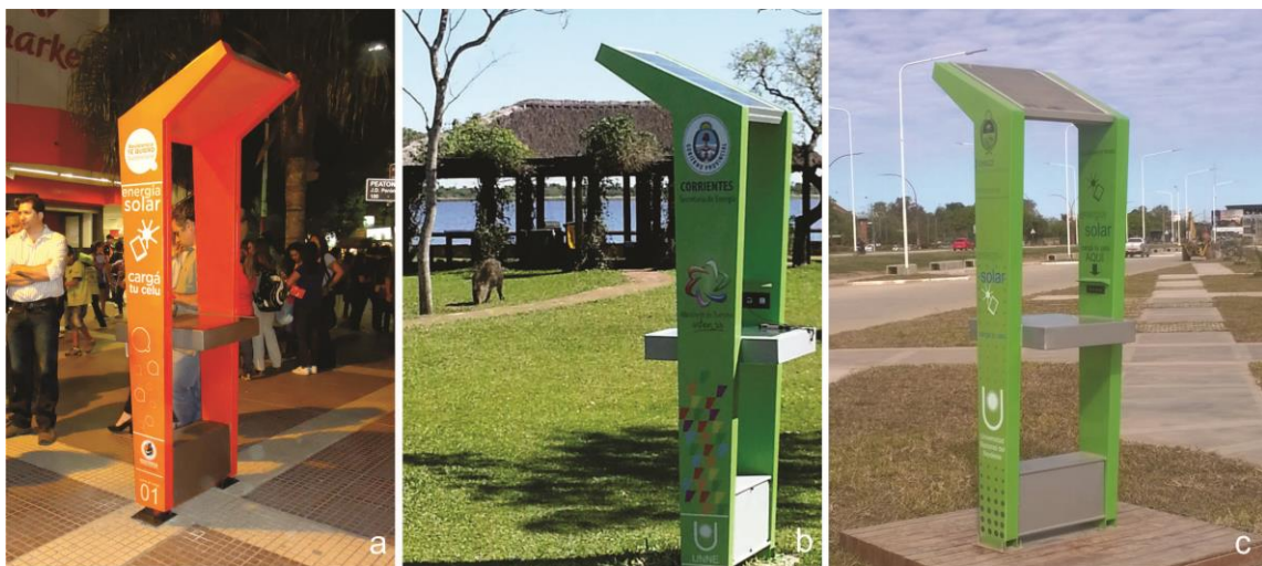
Figura 3 - Distintos cargadores solares instalados en la Región NEA. Fuente: elaboración propia.
