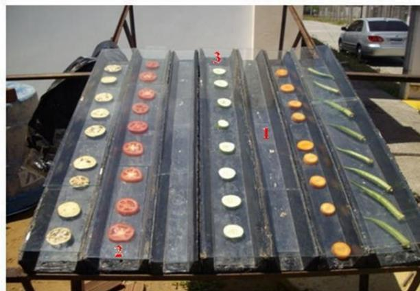
Figura 14 – Secadores solares propostos, em teste (1-luminária menor, 2-luminária intermediária, 3-luminária maior).
