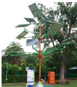
Figura 3 - Solar Power Tree : árvore solar indiana de tronco único com derivações. (Fonte: Distasio, 2016).
