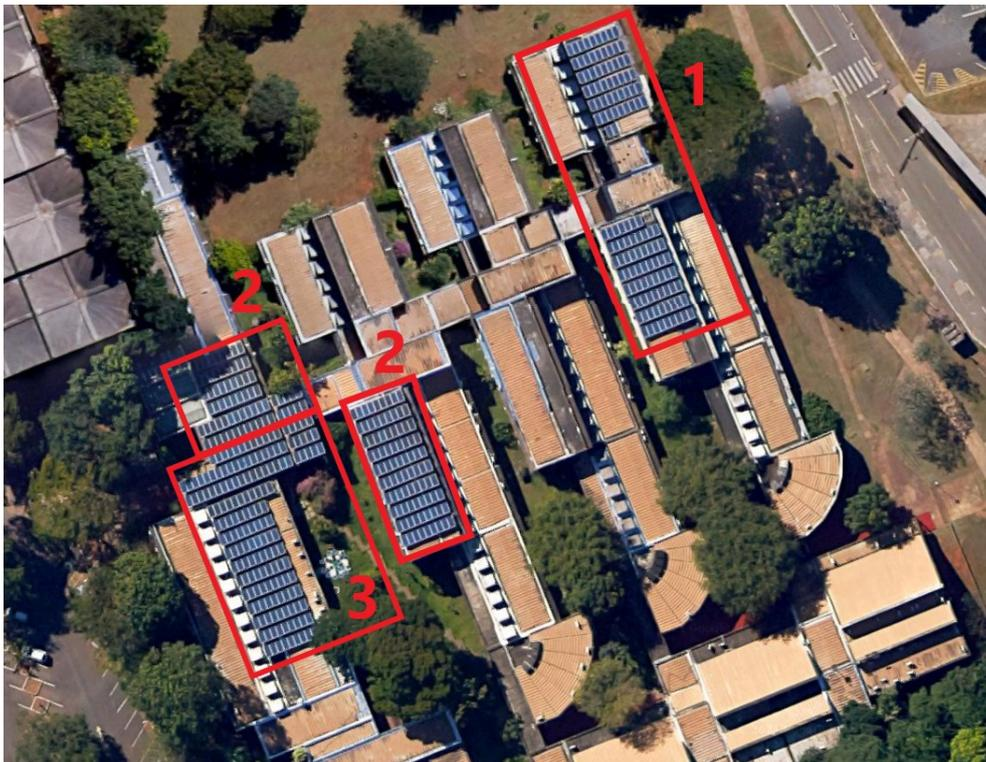
Figura 3 – Imagem de satélite da Usina Fotovoltaica da Faculdade de Tecnologia – FT/UnB com a indicação da subdivisão dos 3 subsistemas.
