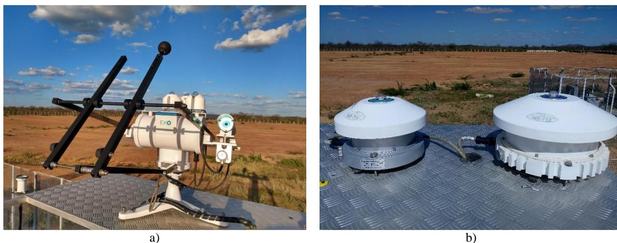
Figura 1 – Sensores de radiação solar da Plataforma Solar de Petrolina: a) Piranômetros e pireliômetro; b) espectralradiômetros.
