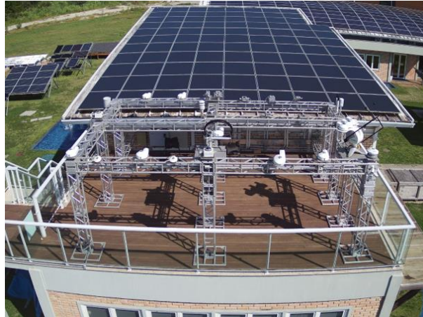
Figura 5 - Estação solarimétrica do laboratório Fotovoltaica-UFSC, onde estão localizados os sensores solarimétricos e ambientais cujos dados são utilizados para nas análises apresentadas neste estudo.
