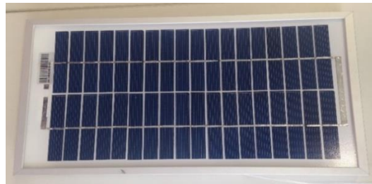
Figura 7 - Módulo utilizado, servindo como célula padrão para medição da irradiância.
