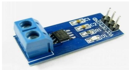
Figura 4 - Placa do sensor de corrente modelo ACS712. Fonte: Allegro Microsystems (2014).
