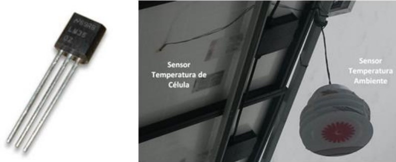
Figura 6 – Sensor de temperatura LM35 e seus locais de instalação.
