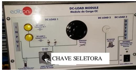
Figura 6- Chave seletora da carga eletrônica c.c..
