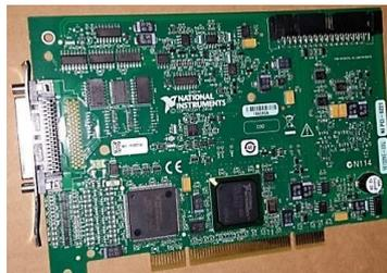
Figura 7- NI PCI – 6221 (16 entradas analógicas, 24 portas digitais E/S, 2 saídas analógicas).
