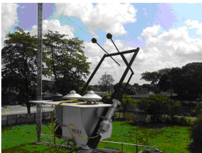
Figura 3 – Rastreador Solys 2 utilizado para realizar as medidas difusa.
