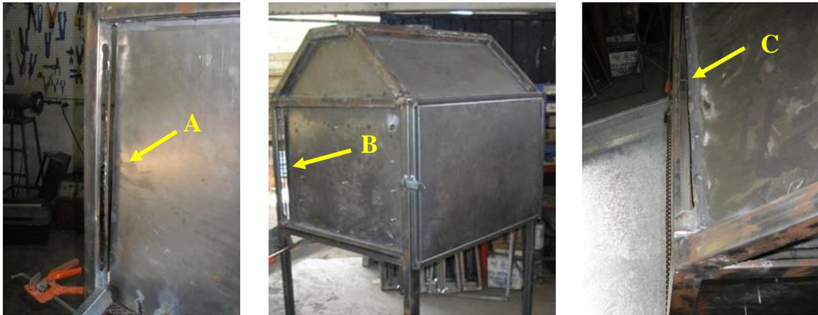
Figura 5 - Ranuras en la estructura de la cabina de secado. En A y B se indican las ranuras en los parantes laterales y C Ranurado en el parante superior.
