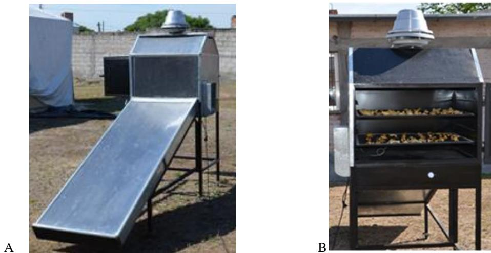
Figura 1- A. Secador con colector de matriz porosa de doble paso. B. Vista posterior del secador
