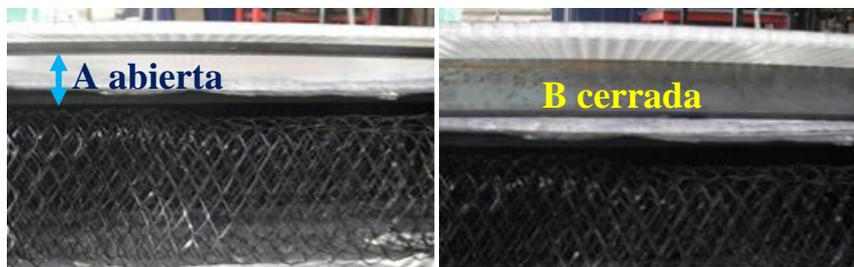
Figura 7 - Detalle del sistema de válvulas que controla del flujo de aire. A. La válvula está abierta lo que permite el paso del aire por el colector. B. La válvula está cerrada evitando que circule el aire por el colector.
