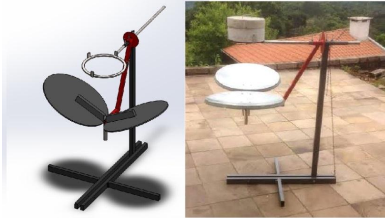
Figura 2 – Desenho do fogão em SOLIDWORKS® e projeto executado. Fonte: Romagna, 2015.
