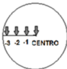
Figura 4 – Diagrama de posicionamento dos termopares no fundo do absorvedor. Fonte: Romagna, 2015.
