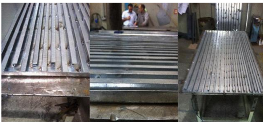
Figura 7 - Dutos fixados na chapa.
