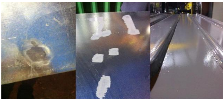
Figura 6 - Modelo do tipo chapa-tubo após receber aplicação de pasta térmica, polimento e tinta anti-corrosiva.
