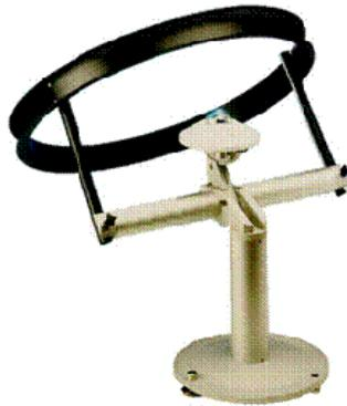
Figura 4 – Modelo de piranômetro com anel de sombra em construção.
