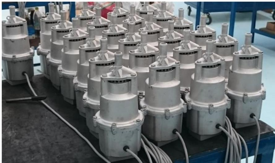
Figura 2 – Bombas submersas vibratórias.
