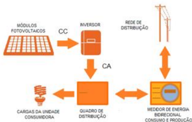
Figura 1 – Sistema de micro ou minigeração fotovoltaico conectado à rede, com sistema de medição bidirecional.
