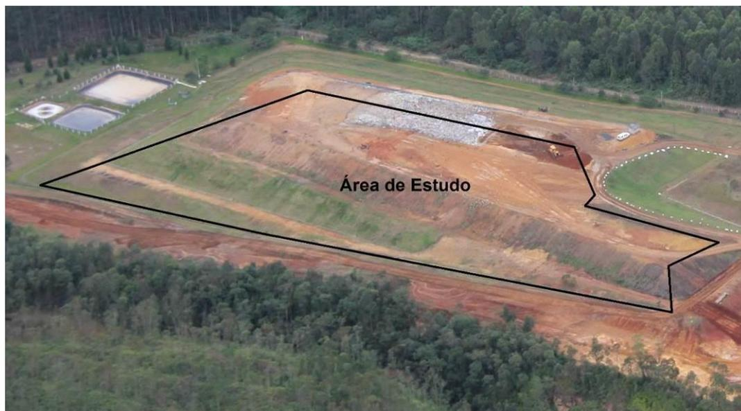
Figura 1 – Área que apresenta maior tempo de incidência solar no aterro sanitário do Cirsures por conta do posicionamento dos taludes para o sentido norte, onde estará apto a instalar os painéis solares fotovoltaicos.
