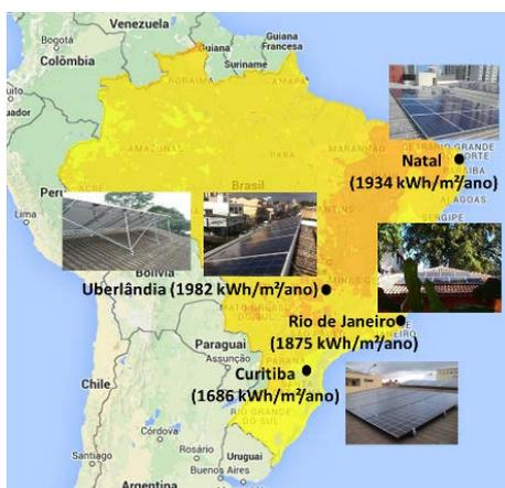
Figura 4 – Sistemas Fotovoltaicos conectados à rede operando em 4 cidades brasileiras e respectivas irradiações globais no plano horizontal (Inpe, 2015).
