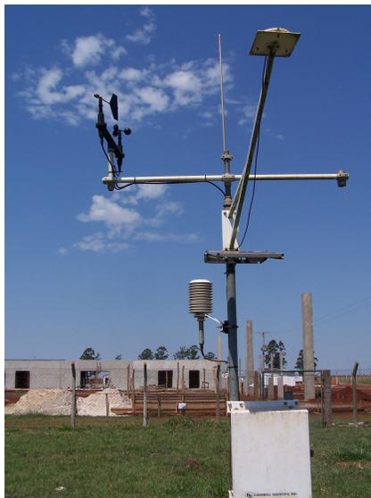
Figura 1 – Estação meteorológica da UFGD. Fonte: Próprio autor (2008)
