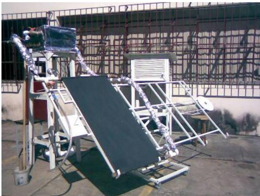
Figura. 1- Foto da bancada de teste e do coletor solar.
