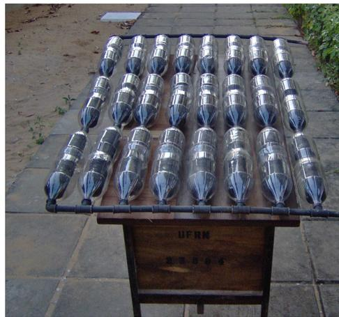
Figura 5. Coletor com latas fechadas.
