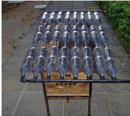
Figura 4. Coletor com latas semi-abertas.
