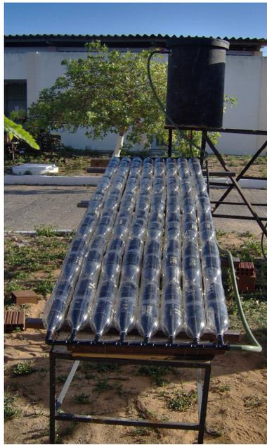
Figura 6. Coletor aletado duplo.
