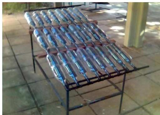
Figura 3. Coletor PET aletado.
