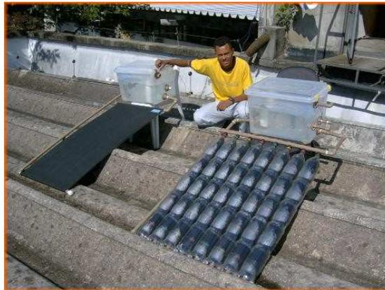
Figura 2. Coletores ASBC e Coletor PET em teste (COSTA, 2007).
