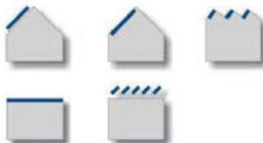
Figura 3 – Painéis FV integrados a diferentes *lay-outs* de telhados.
