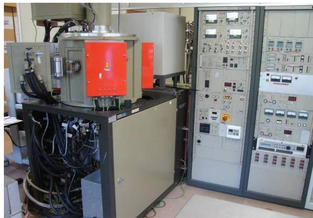
Figura 2 - Ilustração do equipamento Balzers BAS 450MS para deposição catódica por “Magnetron Sputtering”.
