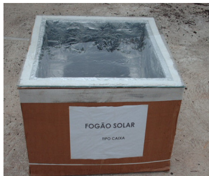
Figura 1 – Fogão solar tipo caixa revestido de papel alumínio
