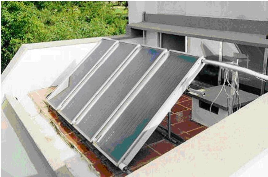
Figura 2 – Fotografia do SSAA operando por termossifão na bancada de testes.
