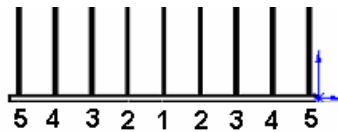
Figura 8. Ordem de numeração dos tubos de elevação pelo método de Kikas et al. (1995).
