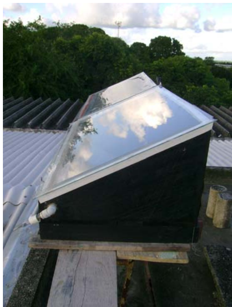
Figura 2 – Vista lateral da unidade experimental de dessalinização solar construída no LASSOP.
