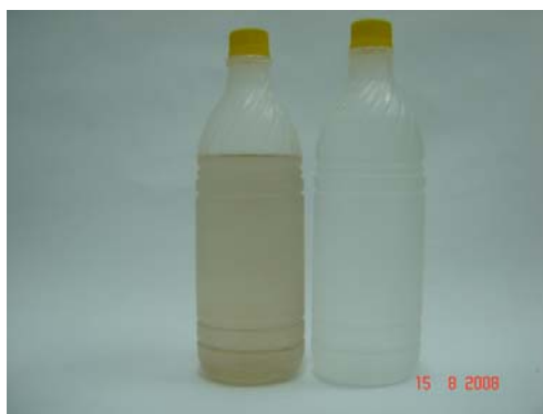
Figura 10 – Aspecto visual da água de entrada e saída nos dessalinizadores
