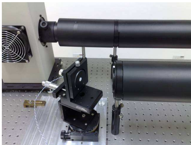
Figura 5 - Detalhe da bancada ótica com dispositivo para medida de resposta angular (lei dos cossenos).
