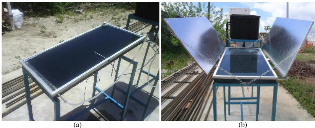
Figura 2- Reator solar utilizado nos ensaios de fotólise e fotocatalise, sem concentrador solar (a) e com concentrador acoplado (b).
