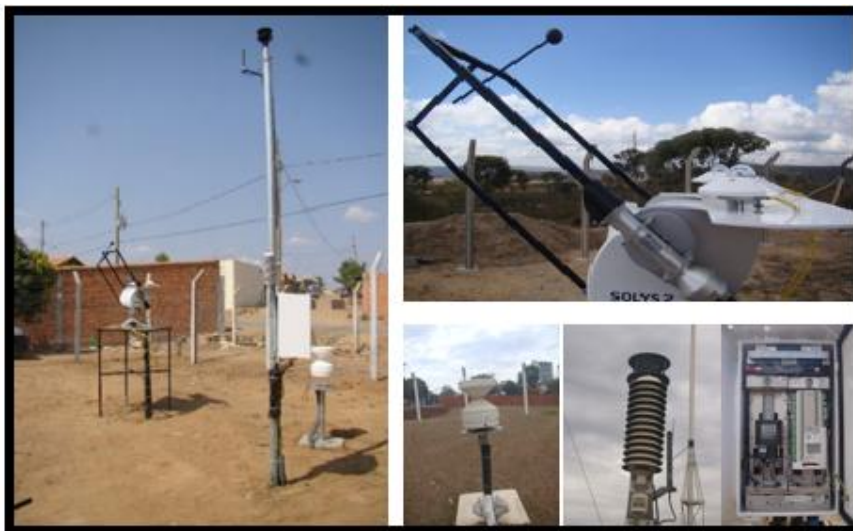
Figura 2 - Estação solarimétrica e sensores implementados em Jaíba – MG (Fonte: P&D GT 468 CEMIG / ANEEL).
