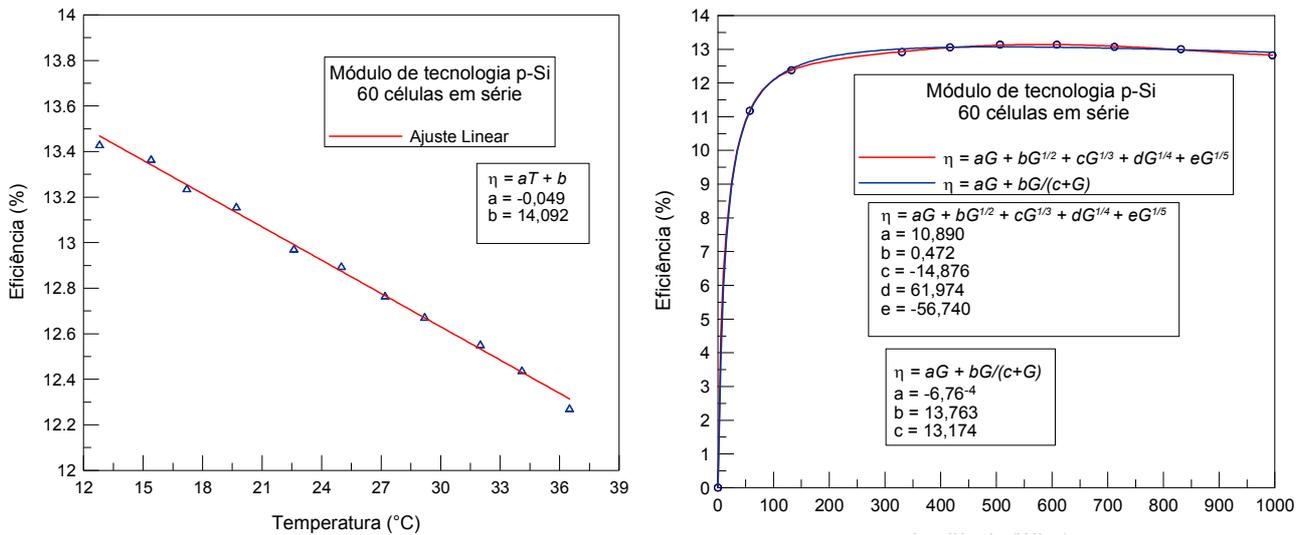
Figura 5 - Variação da eficiência de conversão de um módulo de silício policristalino (60 células em série) com relação à a) temperatura e b) irradiância.
