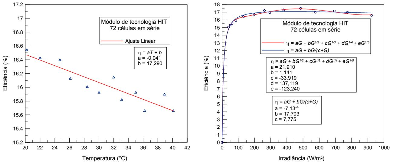
Figura 8 - Variação da eficiência de conversão de um módulo de tecnologia HIT (silício monocristalino envolto por duas camadas de silício amorfo com 72 células em série) com relação à a) temperatura e b) irradiância.
