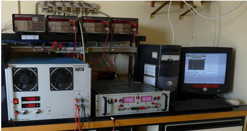
Figura 1 – Equipamento de medida utilizado para a determinação de curvas  $I-V$ .
