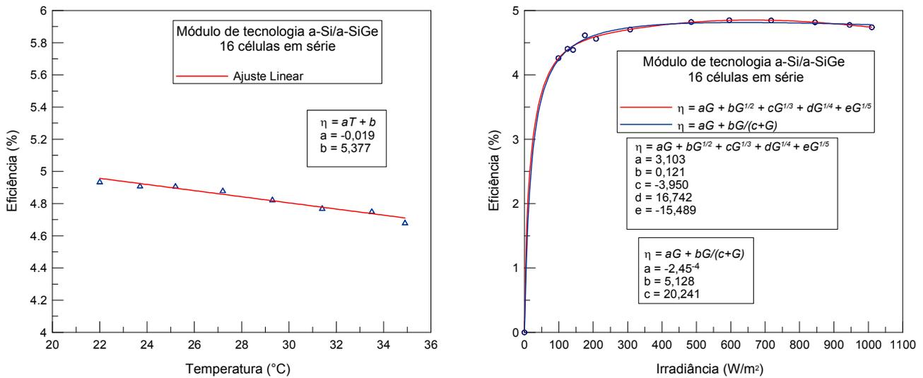
Figura 6 - Variação da eficiência de conversão de um módulo de silício amorfo de dupla união (16 células em série e 4 em paralelo) com relação à a) temperatura e b) irradiância.
