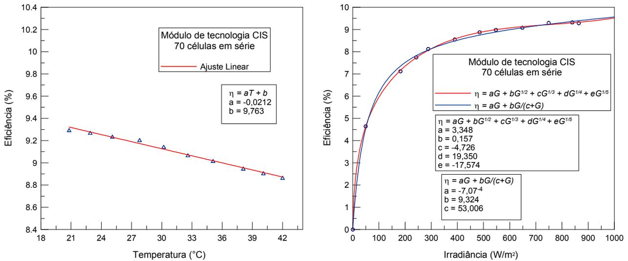
Figura 9 - Variação da eficiência de conversão de um módulo de tecnologia CIS (70 células em série) com relação à a) temperatura e b) irradiância.
