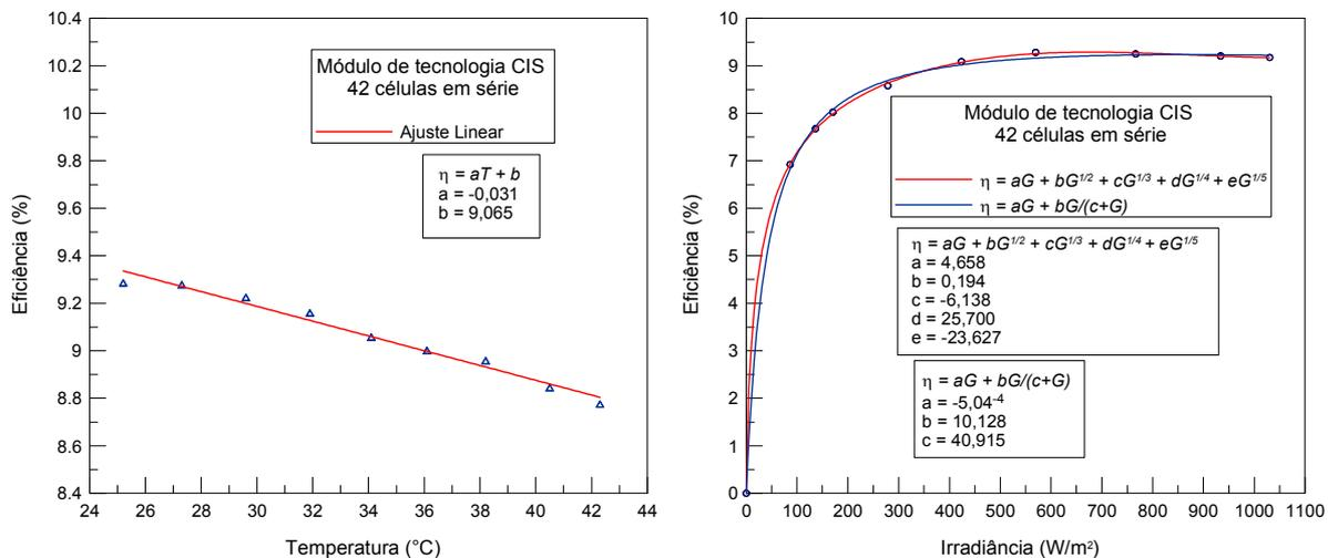
Figura 4 - Variação da eficiência de conversão de um módulo de tecnologia CIS (42 células em série e 2 em paralelo) com relação à a) temperatura e b) irradiância.
