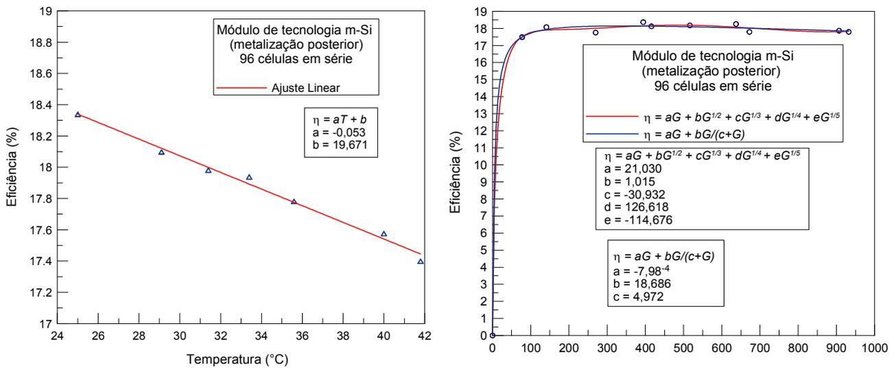
Figura 7 - Variação da eficiência de conversão de um módulo de silício monocristalino de alta eficiência (96 células em série com metalização posterior) com relação à a) temperatura e b) irradiância.
