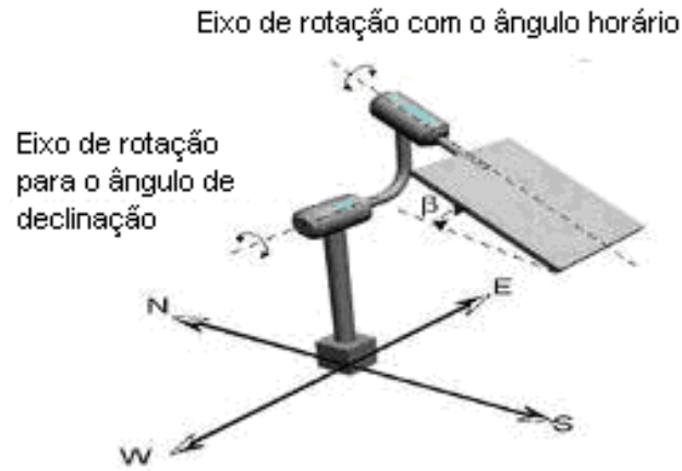
Figura 9 - Sistema de seguimento solar equatorial. (Alata et al, 2005)
