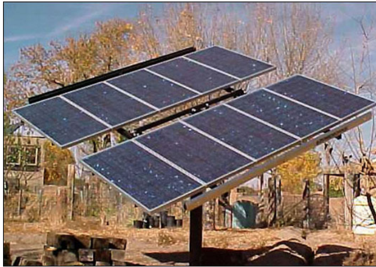
Figura 5 – Rastreador solar passivo da Zomeworks. Fonte: < http://zomeworks.com/products/pv-trackers >
