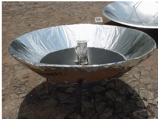
**Figura 4.** Fogão 4 Tipo Concentrador Cônico.
