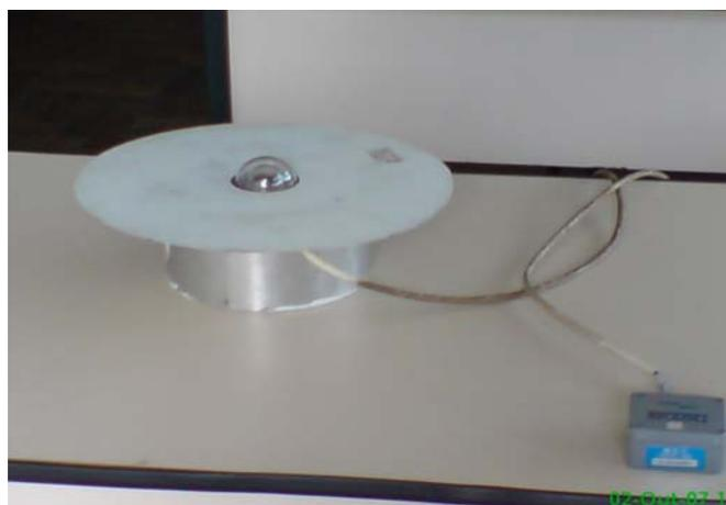
Figura 3 – Piranômetro conectado ao sistema de aquisição de dados (Log Box).
